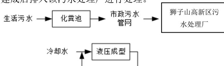
图 3-1 项目污水处理流程图
